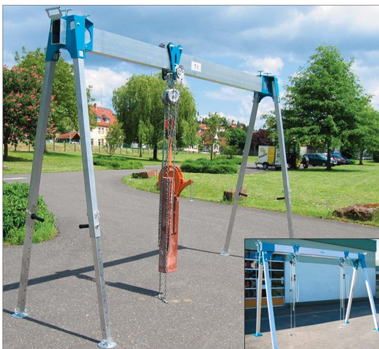
På bilden är löpvagnen haspeldriven och har ett manuellt snabblyftblock.
